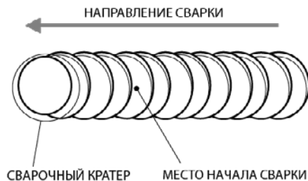
Рис. 10.4. Начало сварки при смене электрода.
